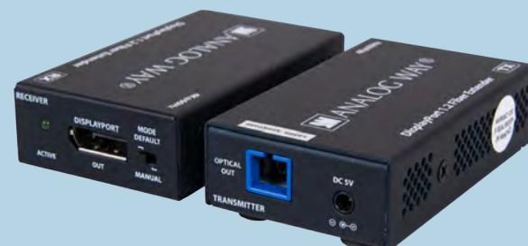
EXT-DP12-OPT は DisplayPort が非圧縮信号をシングル SC マルチモードファイバー 1 本で 200 メートルまで延長できるようにする **DisplayPort 1.2 fiber optical extender** (トランスミッターとレシーバーのキット) です。EXT-DP12-OPT エクステンダーはリアル 4K UHD (3840x2160 または 4096x2160@60Hz) 解像度と 21.6 Gbps までのビデオ帯域幅をサポートします。コンパクトなデザインになっていますので様々な設置環境やライヴイベントに最適です。
