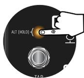
左側の **TAP** フットスイッチの上にある LED ボタンを押しながら電源を投入します（起動には3秒を要します）。フロントパネルの全 LED が3回点滅します。
