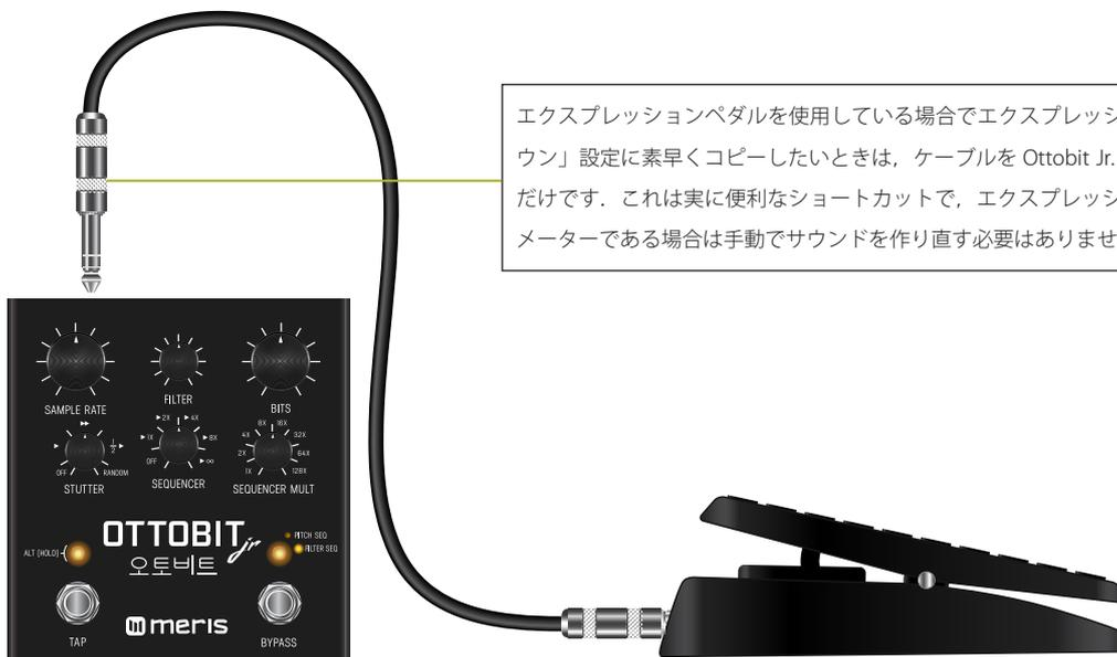
エクスプレッションペダルを使用している場合でエクスプレッションペダルの「トゥアップ」設定を「トゥダウン」設定に素早くコピーしたいときは、ケーブルを Ottobit Jr. の EXP ジャックから抜いてから差し込み直すだけです。これは実に便利なショートカットで、エクスプレッションペダルで変更したいのはただ1つのパラメーターである場合は手でサウンドを作り直す必要はありません。
